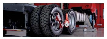
优胜laser AM同样可以用来测量车架,只要增选车架测量标靶,车架测量报告单或者车架测量软件。车架测量是定位测量的一部分。
